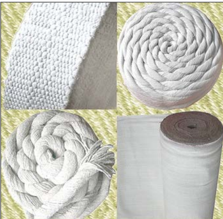
Amiante pur tissé en bandes, en lés ou en cordes.
