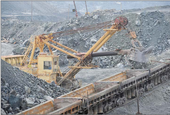
Chargement de roches amiantifères pour les transporter de la mine à l'usine.
