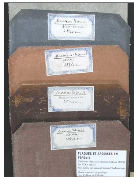
Echantillons de plaques planes en amiante-ciment Eternit teintées dans la masse.
