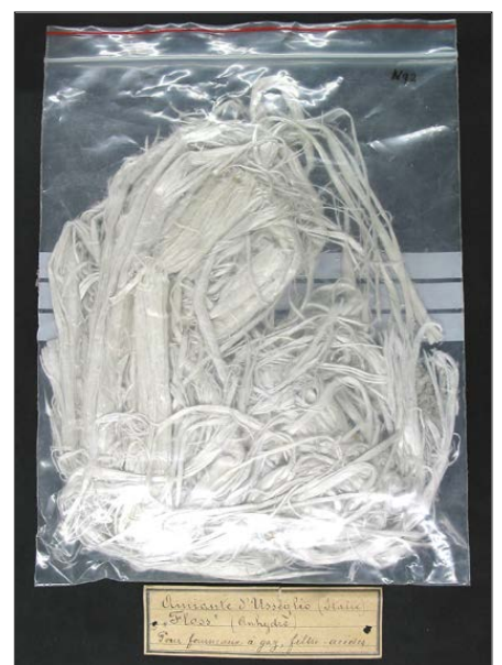
Échantillon d'amiante chrysotile provenant de la mine de Usseglio en Italie utilisé pour les fourneaux à gaz et les filtres pour les acides.
