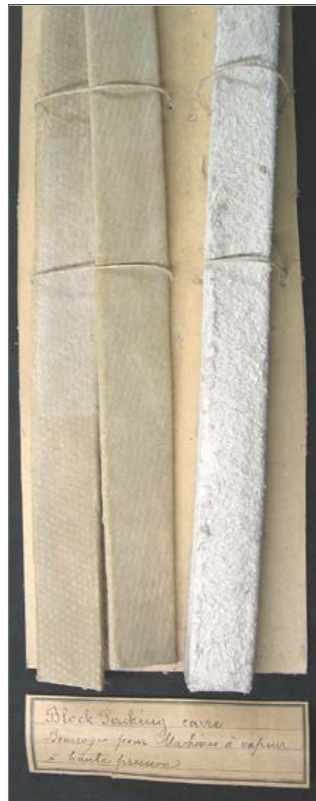
Bourrage pour machines à vapeur à haute pression.
