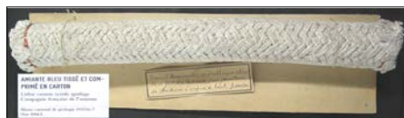
Tresse et carton en amiante pour étancher les machines à vapeur à haute pression.
