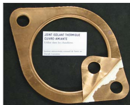
Joint d'étanchéité en cuivre et amiante pour les chaudières.
